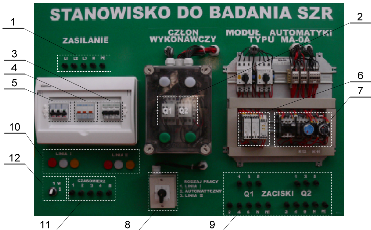
Rys. 2. Stanowisko do badania SZR: 1 – Zaciski zasilania; 2 – Styczniki Q1, Q2; 3 – Linia II rezerwowa; 4 – Lampki sygnalizacyjne; 5 – Linia I podstawowa; 6 – Układ logiczny; 7 – Przekładniki czasowe K11 i K12; 8 – Przełącznik rodzaju pracy; 9 – Zaciski styczników Q1 i Q2; 10 – Lampki sygnalizacyjne linii I i II; 11 – Zaciski czasomierza; 12 - Przełącznik W
